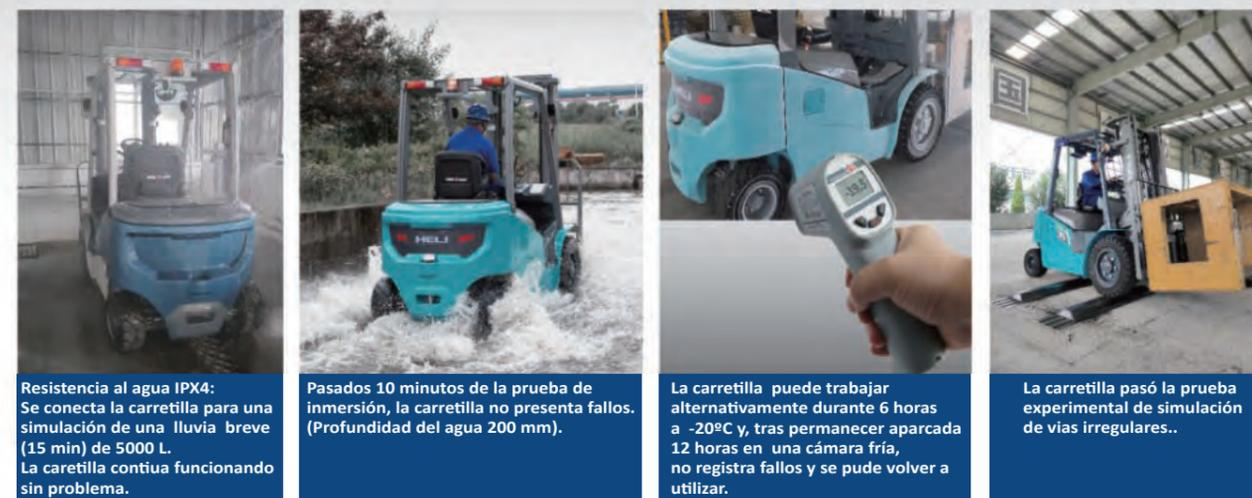
**Resistencia al agua IPX4:** Se conecta la carretilla para una simulación de una lluvia breve (15 min) de 5000 L. La carretilla continúa funcionando sin problema.
