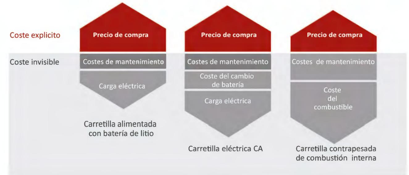
Además, la carretilla HELI con batería de litio no necesita mantenimiento, tiene una alta eficacia de conversión energética y su coste de funcionamiento total es más económico.
